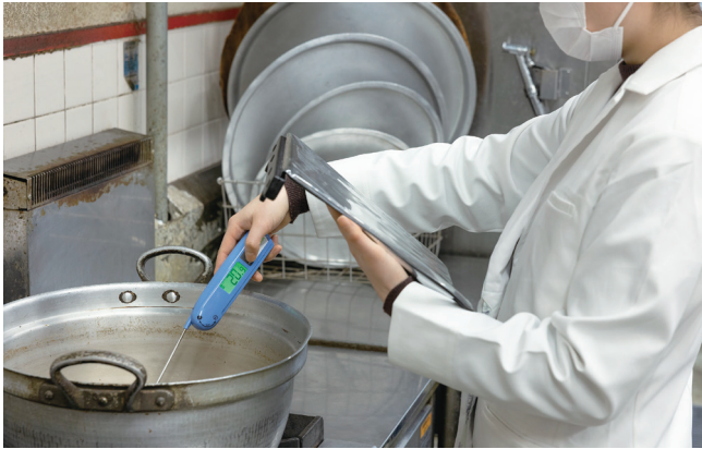
iPadと連動させて中心温度を測定
