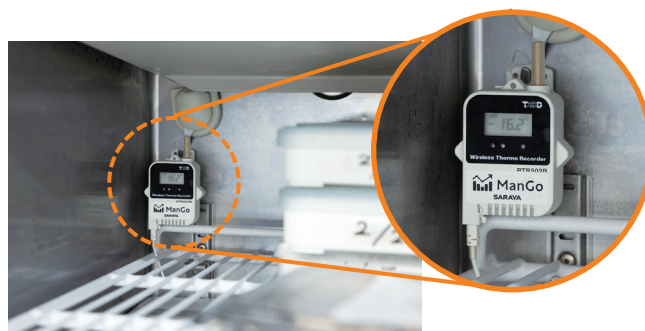
ワイヤレス温度計による冷機器自動温度測定
